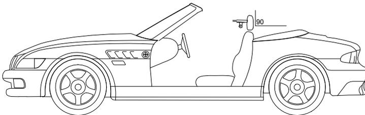
Микрофон или датчик устанавливается только судьей. Участникам не разрешается изменять его положение, в том числе в перерыве между двумя измерениями. Судьи обеспечивают правильную установку микрофона по высоте и направленности. Эти параметры не меняются в зависимости от типа автомобиля.
